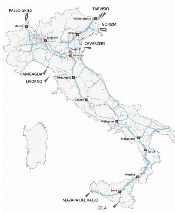
Le 13 centrali di compressione e spinta collegate con la Rete nazionale gasdotti e i punti di ingresso dall'estero (metanodotti e rigassificatori). Fonte SNAM.
